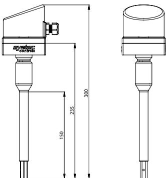
Die Kompaktventuri mit den Anschlüssen G3/4, G1, G1 1/2 Außengewinde bietet auch für geringe Durchflüsse hervorragende Messungen.
