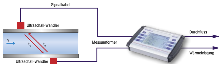
Montage im Z-Modus, typisch bei großen Leitungen
